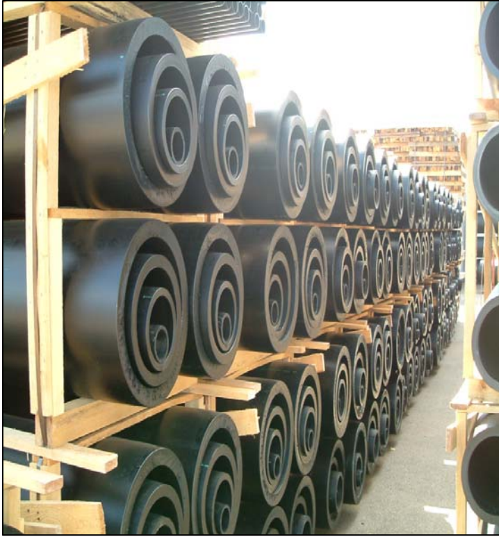
(16 Bar HDPE Fire Mains: AGIP KCO)
